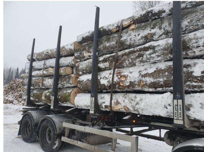
45.att. Kokvedējautomašīnas piekabe kravas nostiprināšana.
