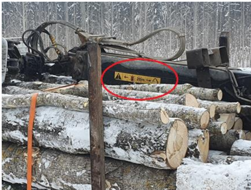
24.att. Kokvedējautomašīnas hidromanipulatora bīstamās zonas norādes piemērs
