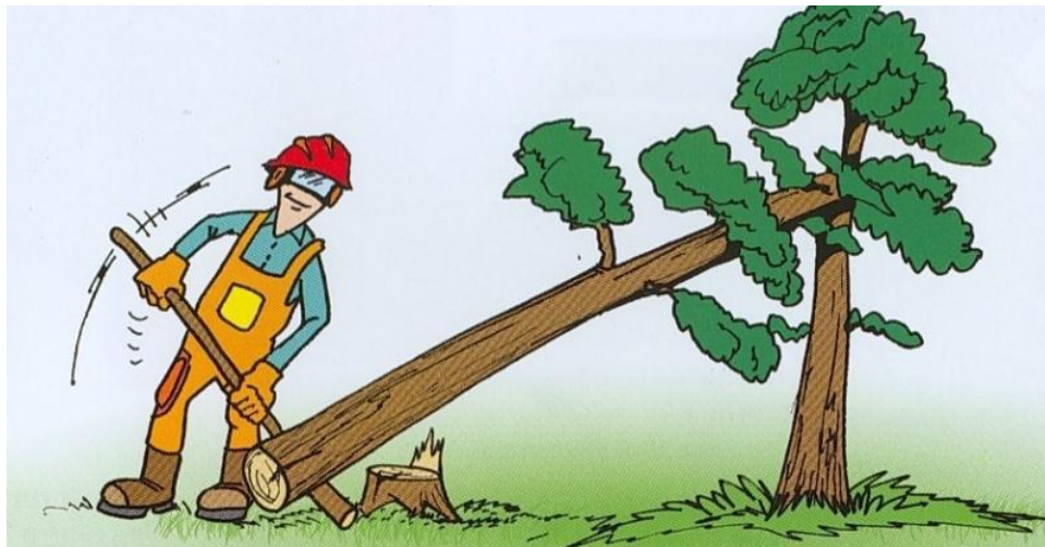
39.att. Koka pārvietošana, izmantojot sviru
