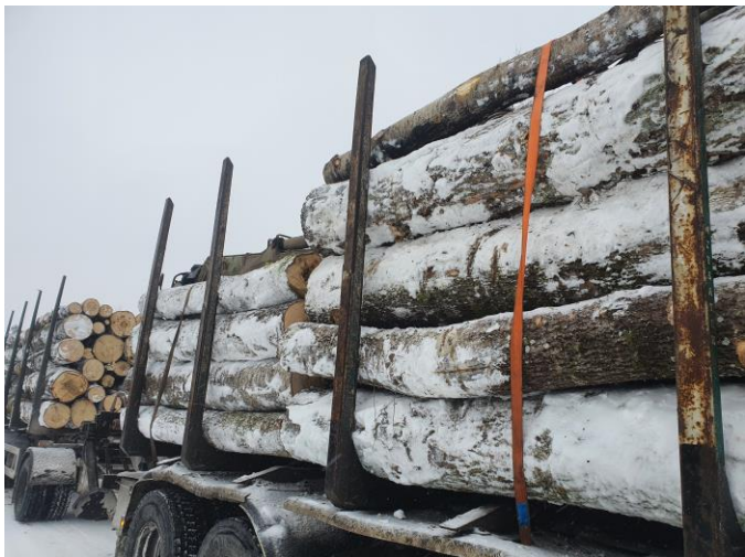
44.att. Kokvedējautomašīnas kravas nostiprināšana.
